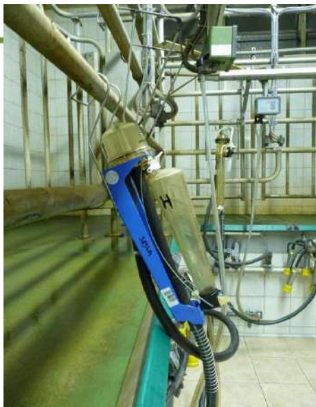
Nepravilna postavitev merilca v molzišču
